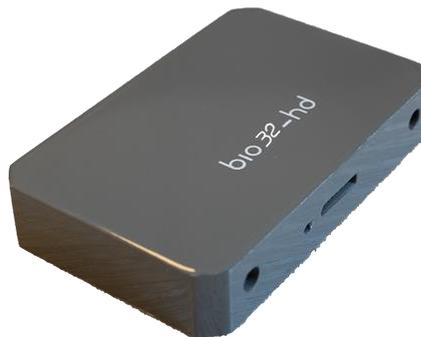
**FIG. 8.6:** Sonda Bio32-HD per matrici di elettrodi a 32 canali
