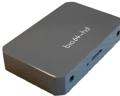
**FIG. 8.5:** Sonda Bio64-HD per matrici di elettrodi a 64 canali
