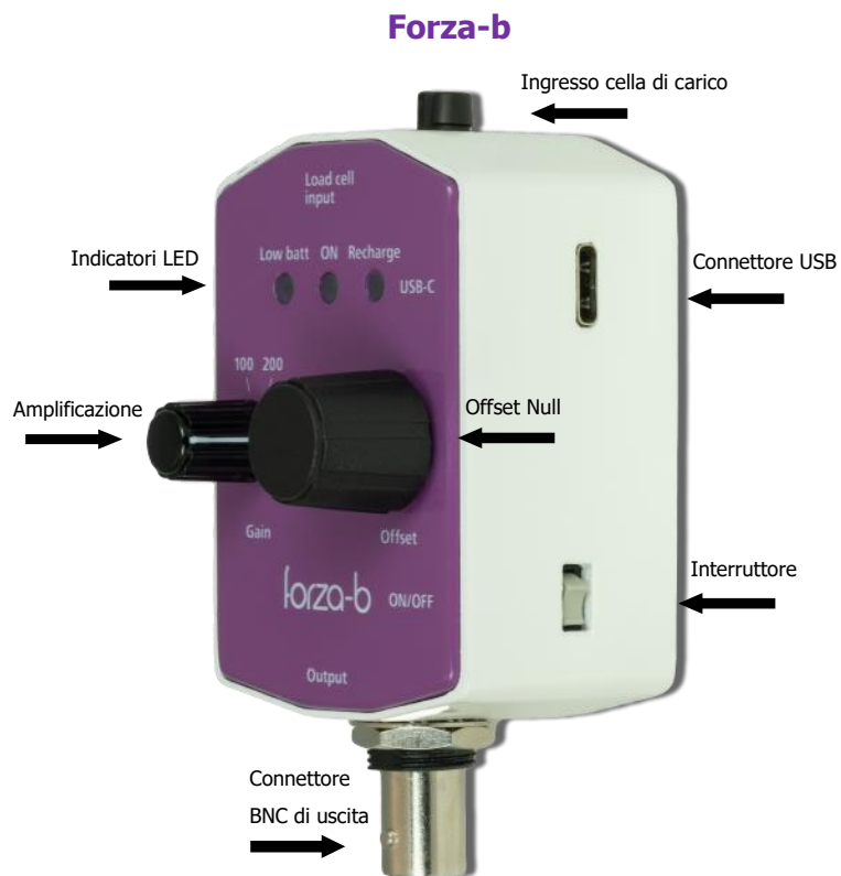
Fig. 7.1: Controlli, indicatori e connettori dell'accessorio forza-b.
