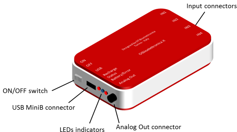
FIG. 7.1: Controlli, indicatori e connettori del Quattro
