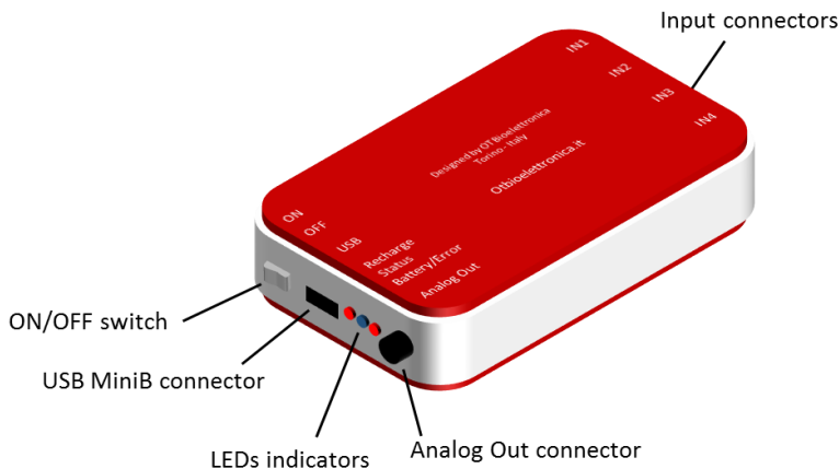
FIG. 7.1: Controlli, indicatori e connettori del Quattro
