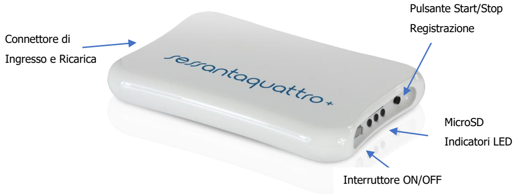
FIG. 7.1: Sessantaquattro+ controlli, connettori e indicatori
